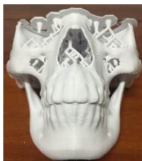
รูปที่ 8 โมเดล 3 มิติ ที่พิมพ์ด้วยเครื่องพิมพ์ 3 มิติ
